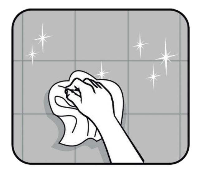
1. Limpe a superfície, se possivel com um desengordurante. Garanta que a superfície está isenta de pó, impurezas e humidade. Deixe secar.
