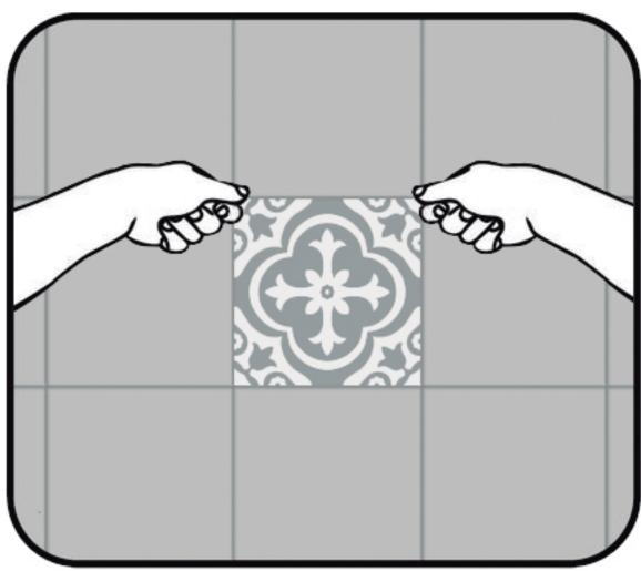
2. Alinhe o azulejo autocolante ao canto superior esquerdo da superfície a revestir.
